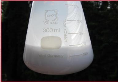
Wenn extreme Oxidations- und Temperaturbeständigkeit gefordert sind, kommt hexagonales Bornitrid zu Einsatz. HCC hat sowohl eine wässrige Dispersion als auch die Pulverkomponente. Für stabile Beschichtungen im Gießereiprozess, als Trennmittel und Festschmierstoff. Als Oberflächenschutz in der Schweißtechnik sowie in der Glasformung.
